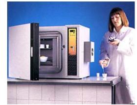
всему объему камеры. Двойная конструкция корпуса камеры предохраняет внешний корпус от нагревания.
