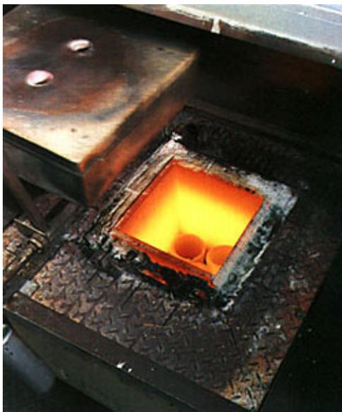
**Конструкция.** Тигельные печи для плавки золота изготовлены из катанного, стального профиля обшитого оцинкованными стальными листами, имеющими износостойкое жаропрочное эпоксидно-полиэфирное покрытие. Верхняя поверхность изготовлена из кирпича, который защищен стальной плитой. Крышка соединена с корпусом печи четырех шарнирным механизмом.
