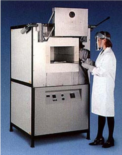
**Конструкция.** Внешний корпус печи изготовлен из листов оцинкованной стали имеющей износостойкое жаропрочное эпоксидно-полиэфирное покрытие. Рабочая камера, потолок и под облицованы карбидокремневыми изразцами, которые устойчивы к воздействию коррозионных паров свинца, выделяющихся в процессе. Двух кожуховая конструкция обеспечивает низкую температуру внешнего корпуса.
